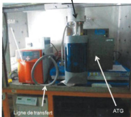
Figure 2. Montage expérimental de traitement thermique d'échantillons de graphite avec l'Equipement d'Analyse Thermogravimétrique (ATG) couplé à un Spectromètre de Masse (SM)
