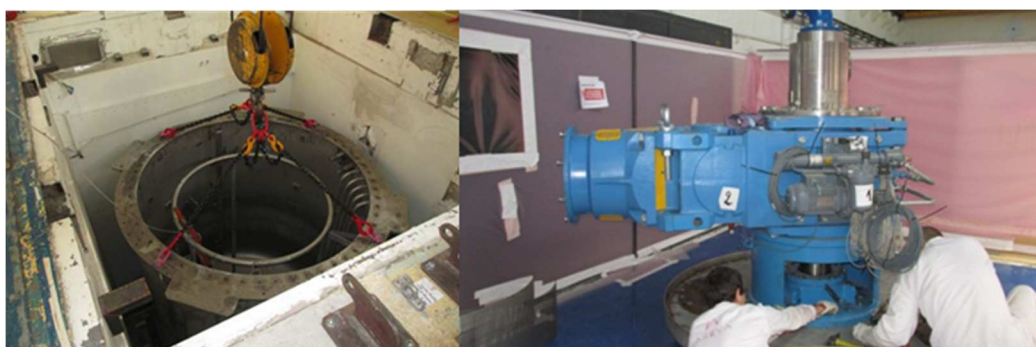
Figure 11. Vue interne du malaxeur et son installation (droite).
