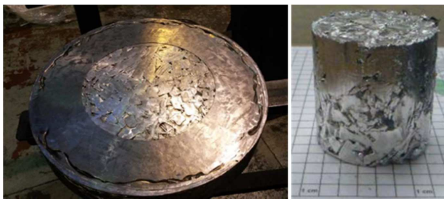
Figure 8. Exemple de cylindres de fragments de gaines Mg simulant inactives après compactage.
