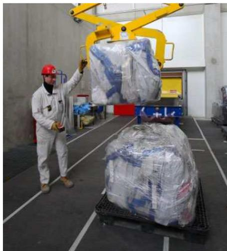
Figure 4 : Balle de déchets issue du compactage en presse à balles (source : Andra, Cires)
