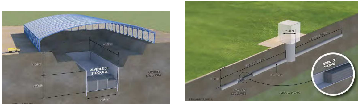
Figure 3-2 Exemple de stockage à ciel ouvert et en souterrain qui pourrait être réalisé sur le site de la CCVS
