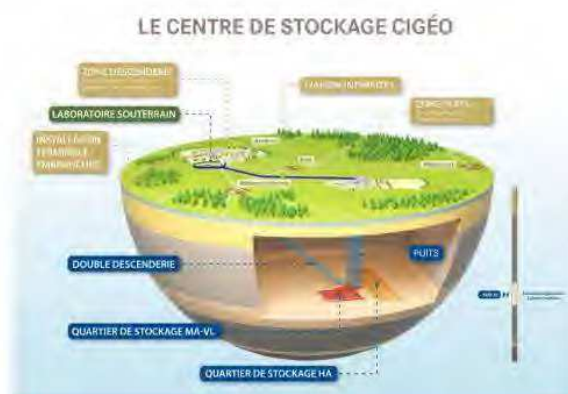
Figure 3-3 Le projet de centre de stockage Cigéo
