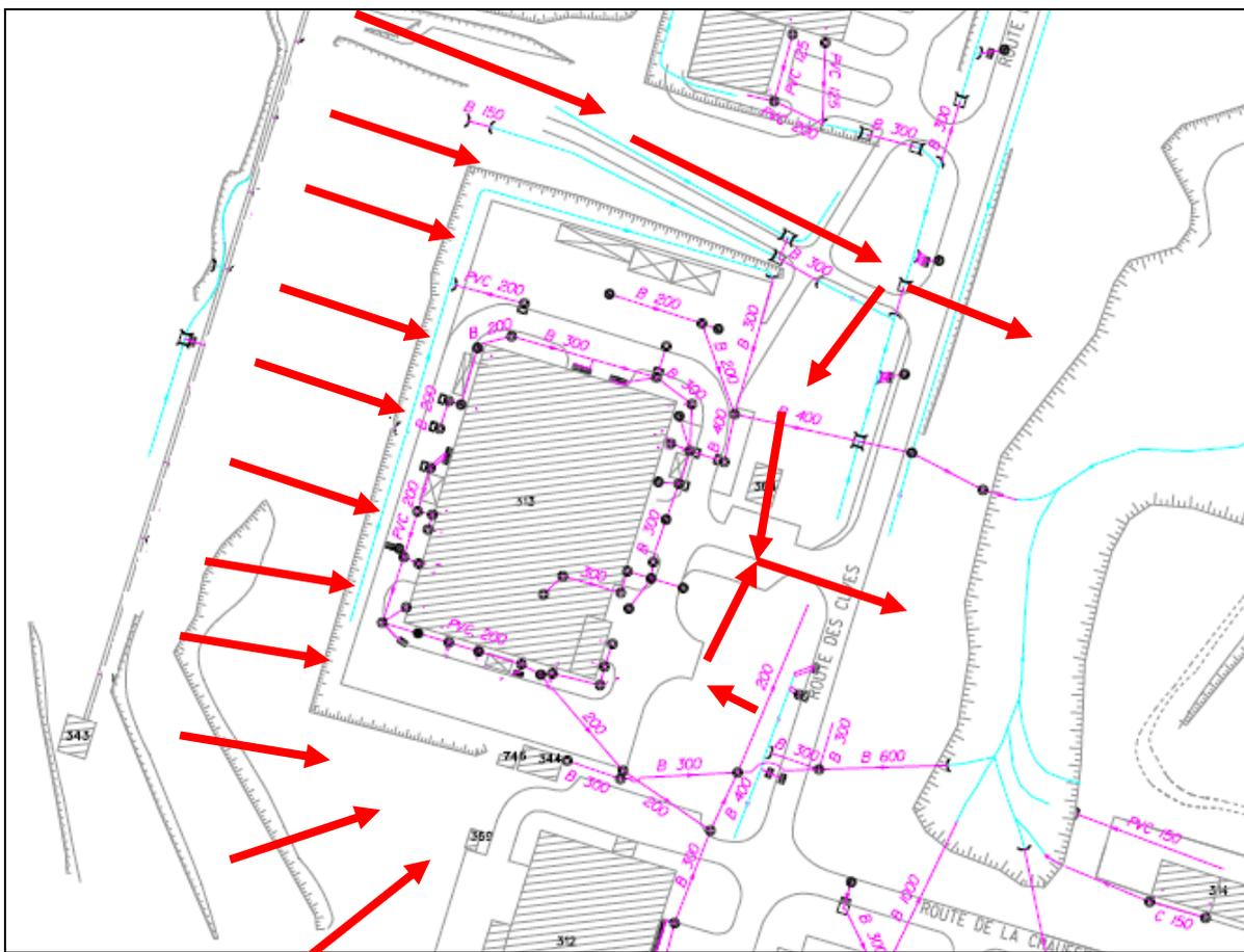
Les dispositions constructives prises (rehausse, formes de pente) autour de l'ensemble des points d'entrées des bâtiments principal et extension permettent de maîtriser le risque d'infiltration.
