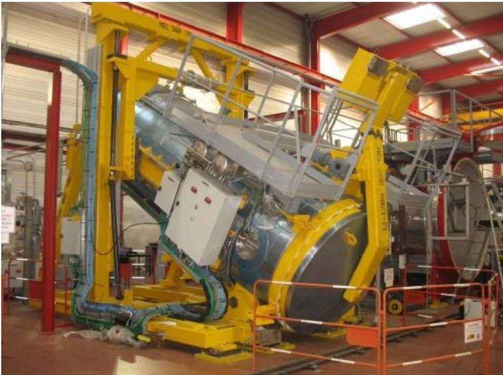
**Figure 68 : Autoclaves AEL de l'atelier REC II en cours de fabrication**
