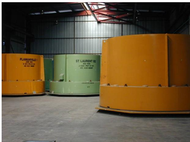
Figure 71 : Entreposage des couvercles de cuves
