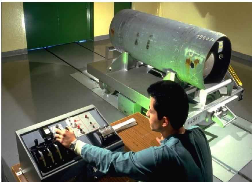
**Figure 39 : Installation de réception expédition contrôle : un conteneur au poste de pesée**
