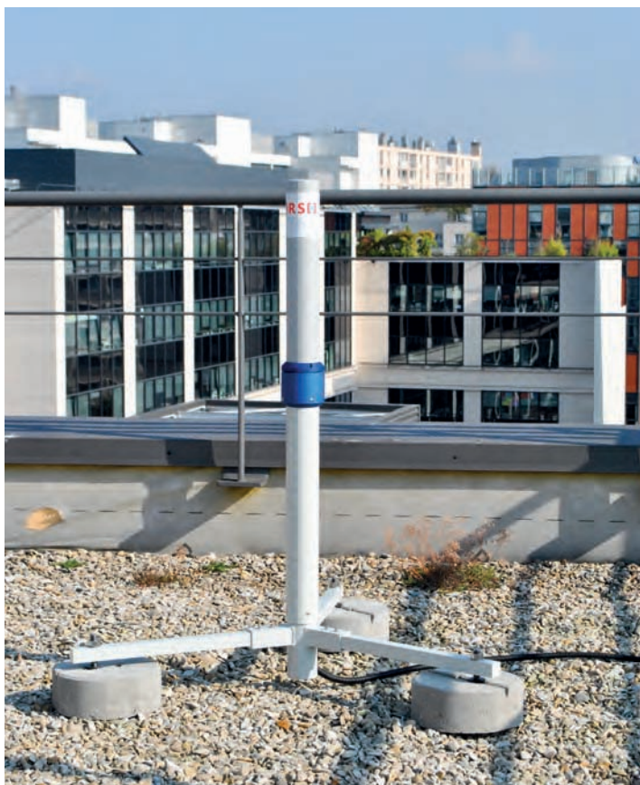
Balise Téléray de l'IRSN sur le toit du siège de l'ASN à Montrouge, octobre 2016
