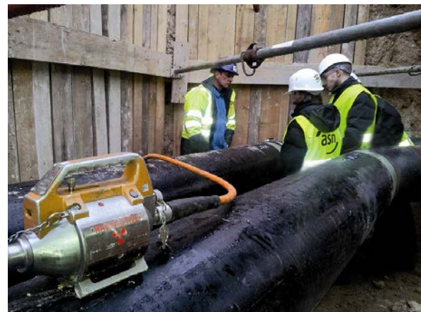
Appareil de gammagraphie industrielle (utilisé par exemple sur les chantiers)
