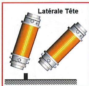
La 1<sup>ère</sup> chute libre sur poinçon vise à endommager au maximum le capot amortisseur de tête qui sert lors de la chute suivante.
