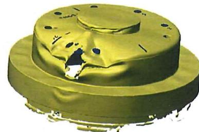
A la fin de la séquence de chute, les mesures d'étanchéité normalisées par gaz traceur Hélium montrent que les deux barrières de l'emballage TN<sup>®</sup>G3 conservent un bon niveau d'étanchéité.
