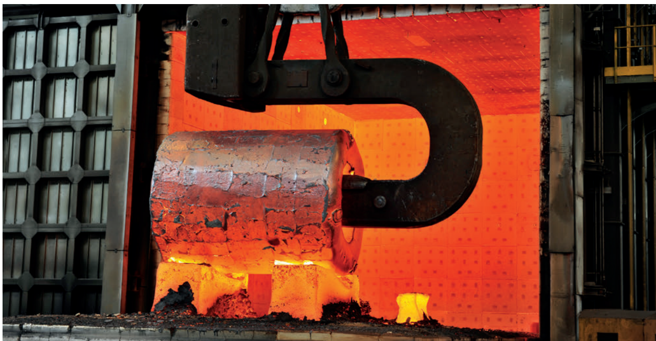
| Fabrication d'une virole.
