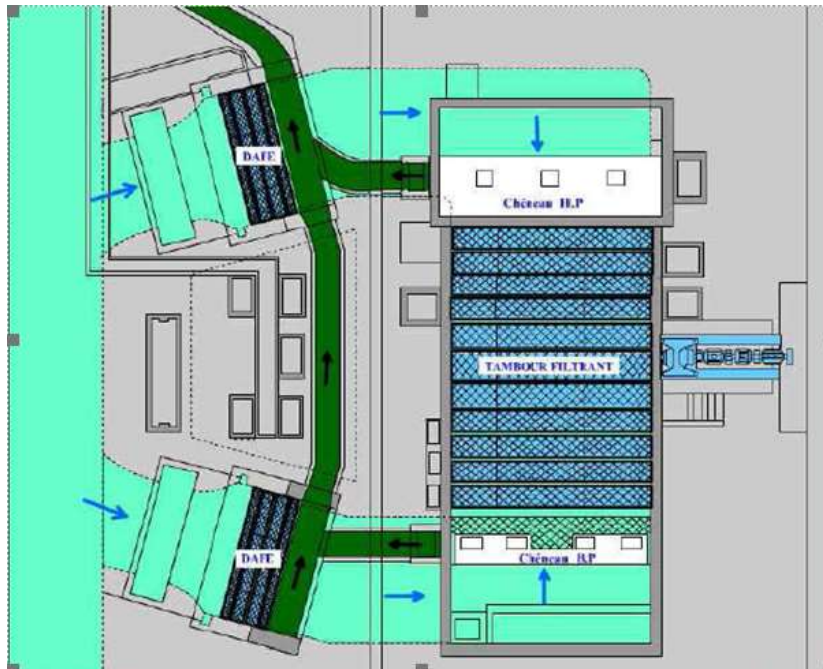
Figure 2 : Dispositifs de filtration complémentaire (DAFE) installés dans les puits en amont du tambour filtrant
