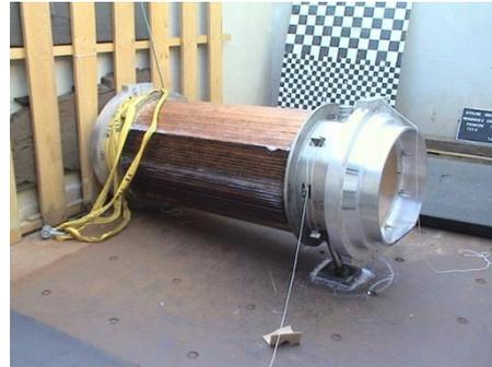
S2 - chute latérale de 9 m (quasi-horizontale)
