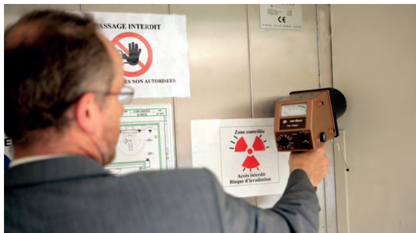
Contrôle du débit de dose avec une babyline au CHU Henri Mondor à Créteil (Val-de-Marne) – Août 2008
