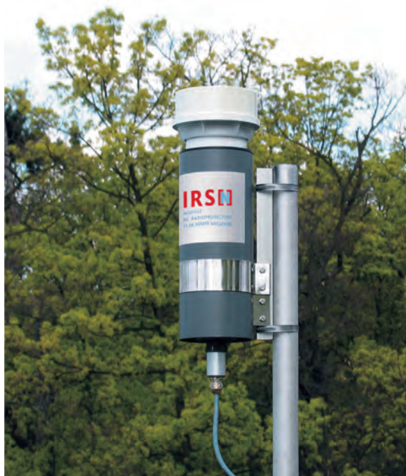
Réseau de surveillance Téléray : balise mesurant en continu la radioactivité gamma ambiante de l'air
