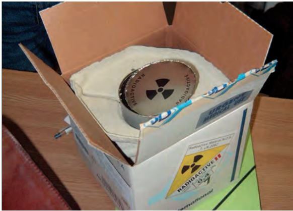
Exemple d'emballage de type A – Colis de radiopharmaceutiques
