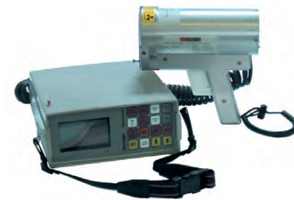
Appareil portable à fluorescence X pour la recherche de plomb dans les peintures – ARELCO
