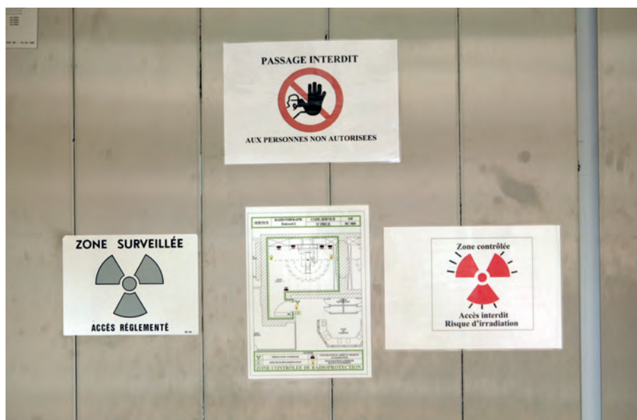
Signalétique de délimitation des zones de travail sous rayonnements ionisants au CHU Henri Mondor à Créteil (Val-de-Marne)
