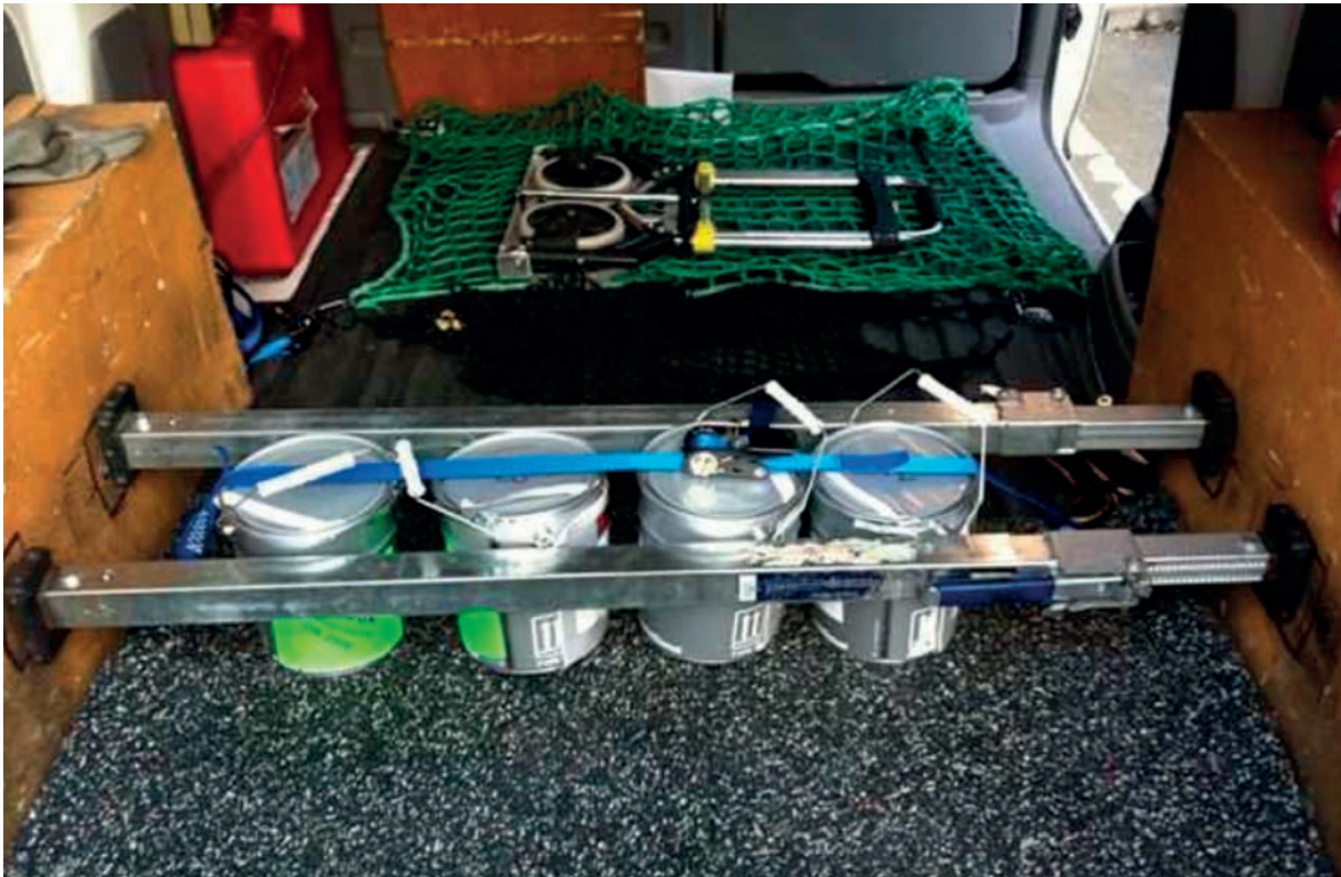
Colis radio-pharmaceutiques arrimés dans un véhicule de transport
