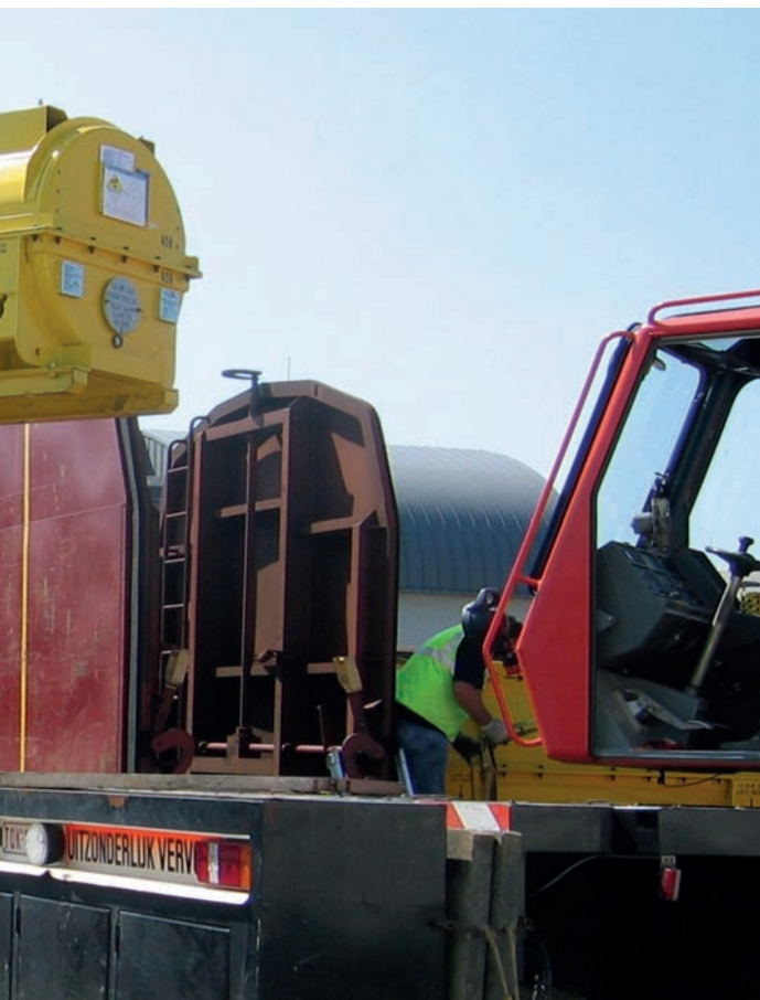
Chargement d'un colis de combustible neuf sur un wagon
