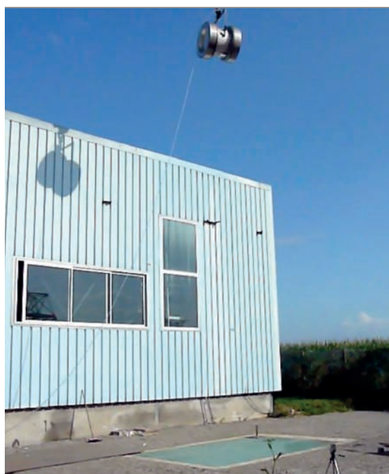
Chute de 9 m d'une maquette d'emballage
