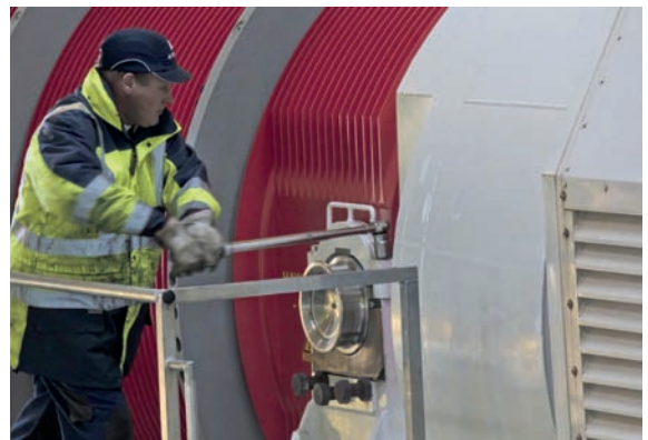
Fixation du CASTOR HAW 28M sur son châssis
