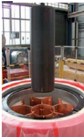
Essai de chargement d'un canister dans un CASTOR HAW 28M
