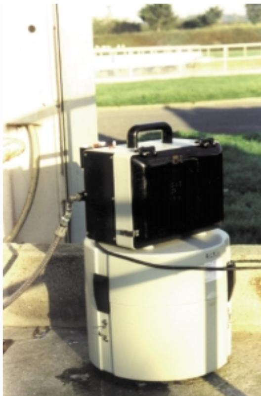
Appareil automatique de prélèvement en continu
