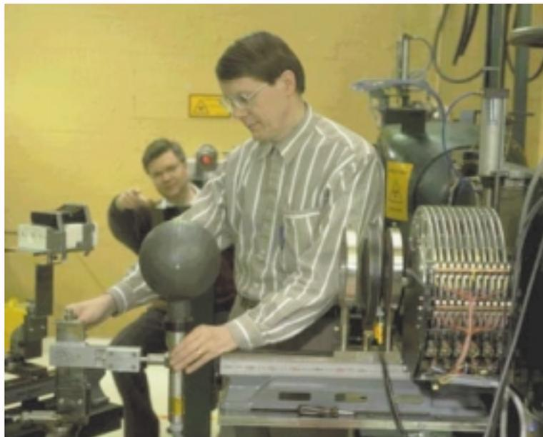
Etalonnage d'un appareil de métrologie des rayonnements ionisants
