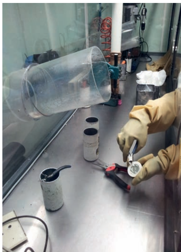
Démantèlement de détecteurs de fumées
